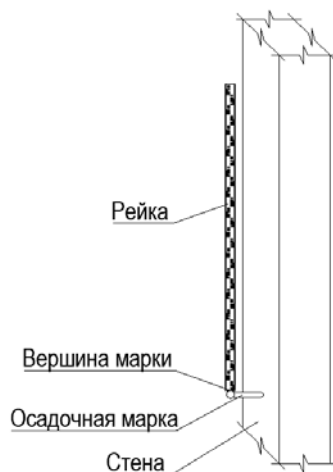
Рисунок 5 – Установка марки
